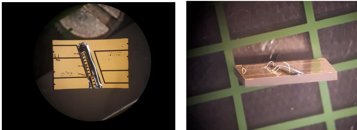
Figure 1 : Deux photos de la même puce à boîtes quantiques sur une embase AlN (vue de dessus à gauche, vue de devant à droite).
