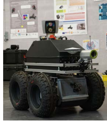
(b) Dispositif placé sur petit robot- véhicule Segway RMP440
