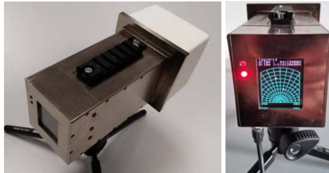
FIGURE 3 – Le radar conçu équipé d'un écran OLED.
