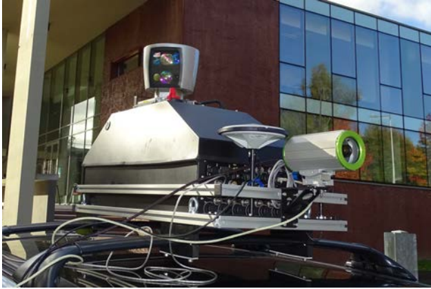
(a) Dispositif placé sur un véhicule routier
