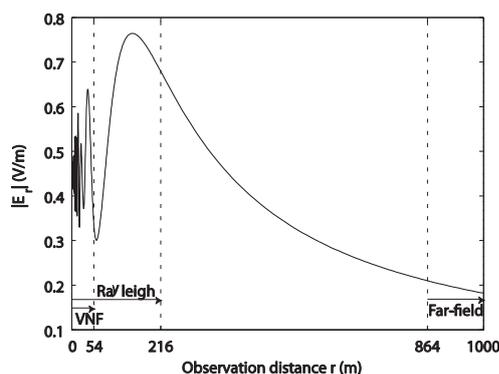
Figure 2. Amplitude du champ électrique réfléchi en fonction de la distance d'observation de la façade [1]
