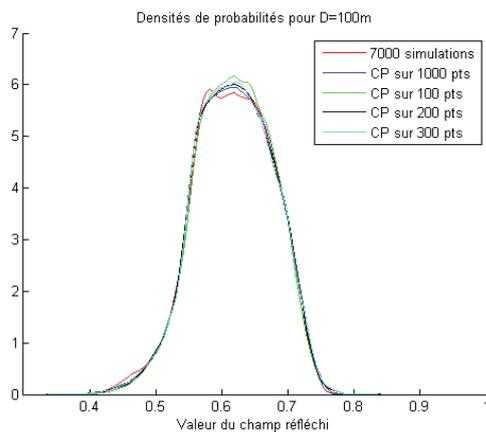
Figure 3. Densités de probabilités du champ réfléchi calculées avec différentes méthodes
