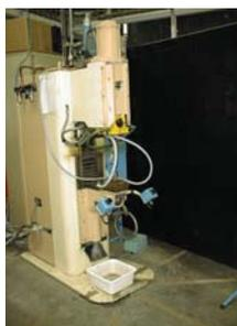
**Machine à souder par points sur châssis**
