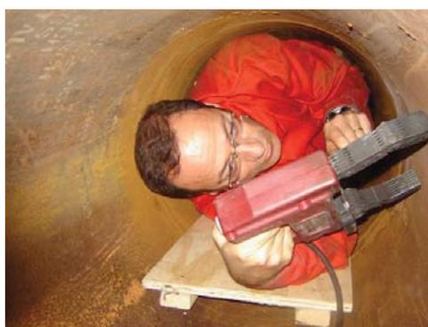
**Figure 2 : Exemple de poste de contrôle par magnétoscopie**
