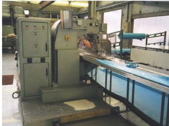
Figure 3 : presse à souder par pertes diélectriques
