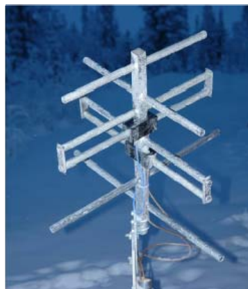
Figure 4: exemple d'élément de type Yagi retenu pour la construction d'EISCAT 3D
