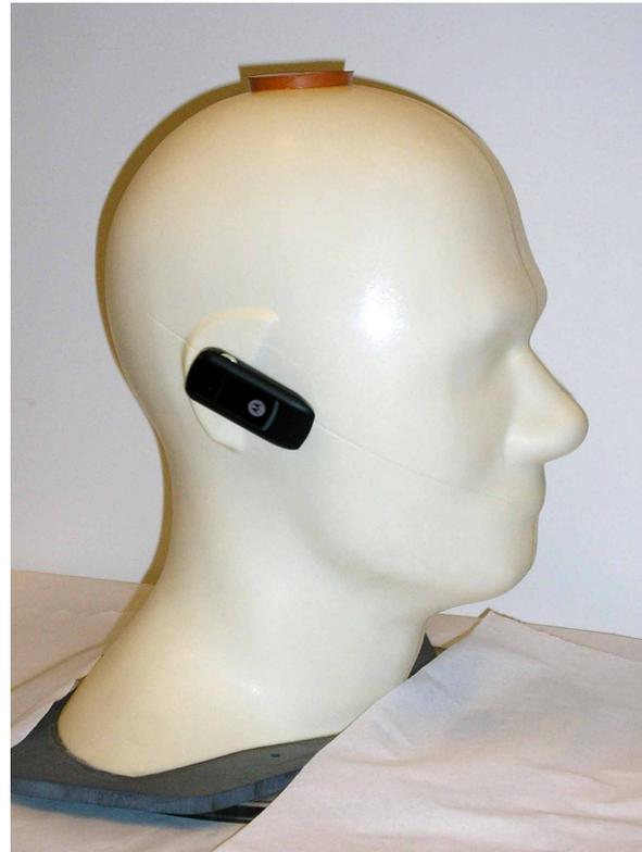
Figure 2 : Oreillette placée sur le fantôme.
