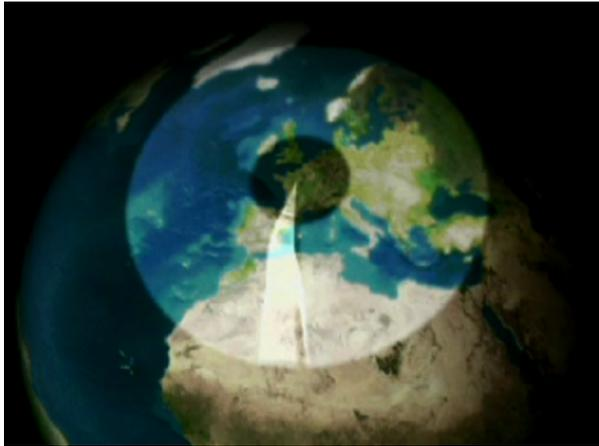
Figure 2: domaine de sondage du radar trans-horizon Nostradamus : une surface annulaire avec un rayon compris entre 900 km et 3000 km au sol
