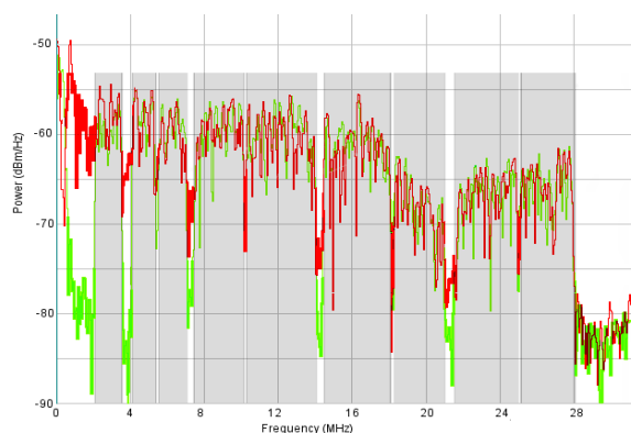
Fig.3. Signal HomePlug AV en présence de bruit impulsif.
