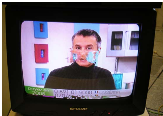
Fig.1 – Impact du bruit impulsif sur la TV sur ADSL
