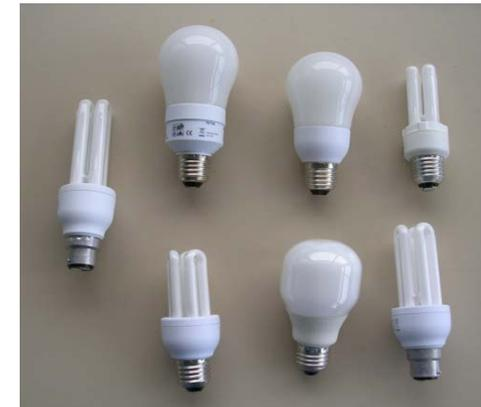
Echantillon de lampes fluo-compactes testées
