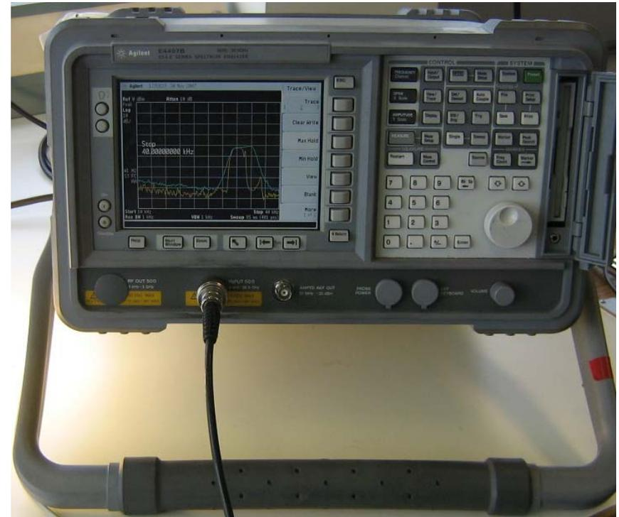
L'analyseur de spectre utilisé pour les mesures sélectives en fréquences
