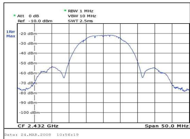
Fig.3. Spectre enveloppe (max-hold) du signal d'un routeur WiFi à la norme IEEE 802.11b
